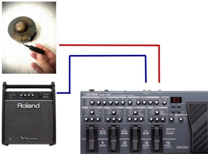
ภาพที่ 3 การเชื่อมต่อ Piezo กับลูกฆ้องและมัลติเอฟเฟกต์
